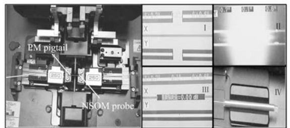
图 8 近场光纤与带尾纤光源的低损耗耦合
